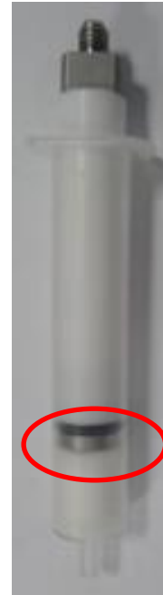
Şekil - 1: Manuel SPE ve SPE-06D arasındaki sızdırmazlık farkı
